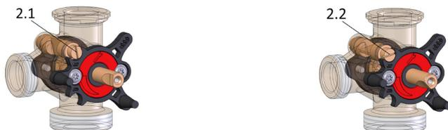
Открытие байпаса имеет смысл, если температура теплогенератора намного выше, чем требуется для отопительного контура (например, при использовании пеллетного котла с системой «теплый пол»). В таком случае без байпаса происходит постоянное подмешивание обратной линии, сервопривод находится в положении закрыт/открыт. С байпасом же ход сервопривода будет более точный и плавный, по всей рабочей шкале.
